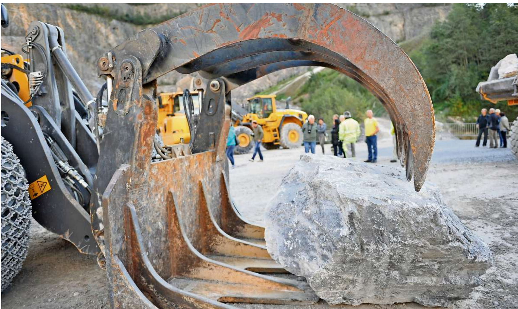
Gewaltig: Mit einer riesigen Zange transportieren Pneulader das Abbruchmaterial vom Steinbruch zur weiteren Verarbeitung in die Werkhallen.
